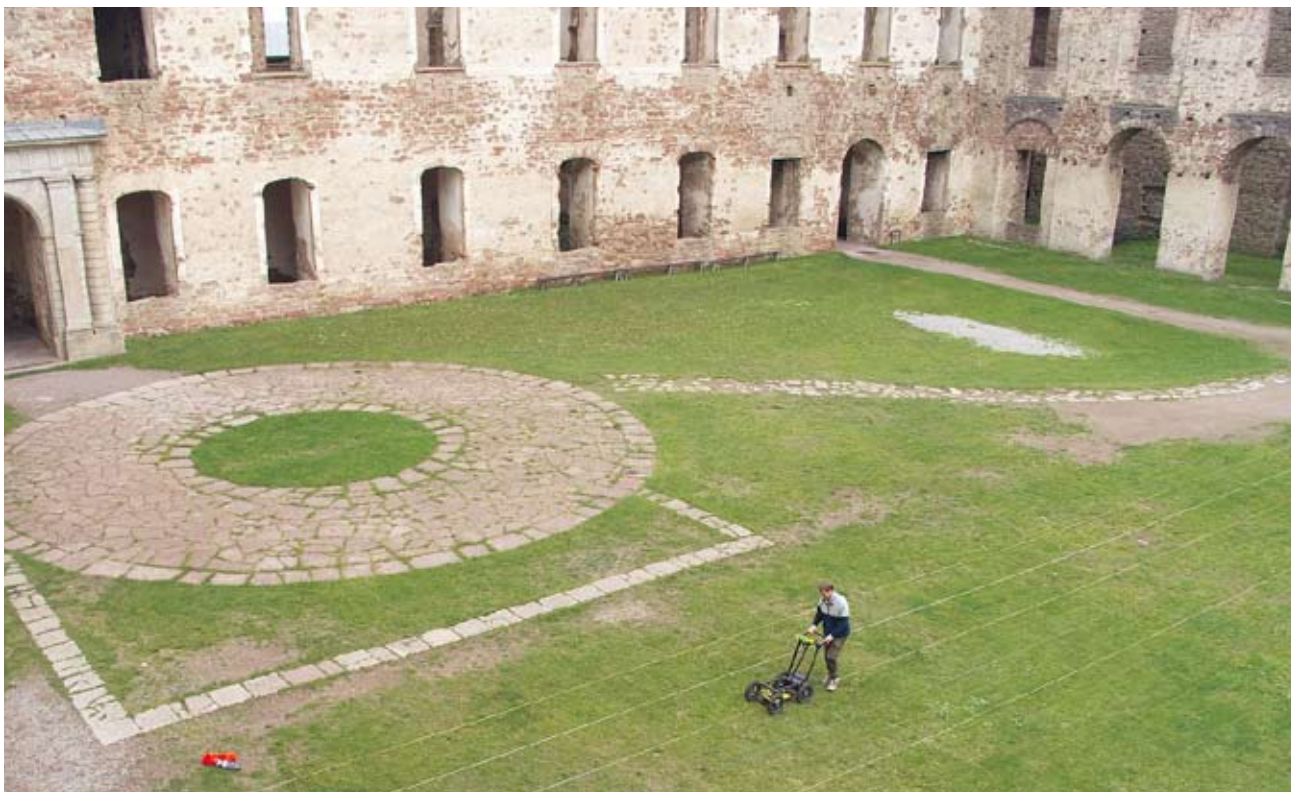
Georadarmätningar på Borgholms slotts inre borggård längs parallella profilsnören. Stenläggningen markerar grundmuren till det gamla kärntornet som undersöktes år 1929.
