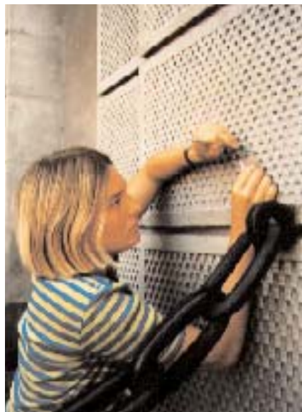
Anna Birath samlar in flagor och färgspår från slottets alla delar. Färgskikten dokumenteras och analyseras.
